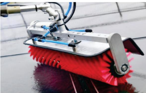
Rotaqleen Solar: Um acessório específico para o sistema solar, possibilitando a limpeza de até 3 mil m<sup>2</sup> quadrados por dia. Com cerdas que não danificam os painéis.
